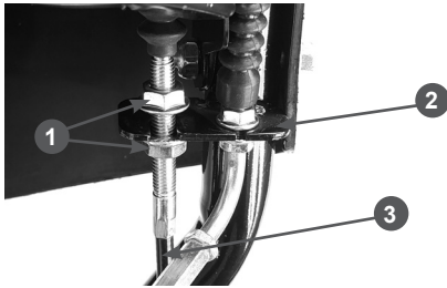
Рис. 11 Крепление оболочки троса включения хода
