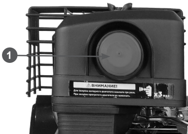
Рис. 34 Расположение ручного топливного насоса
