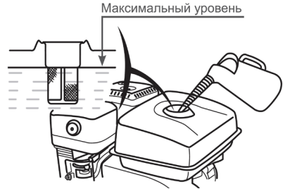
Рис. 28 Максимальный уровень топлива в топливном баке
