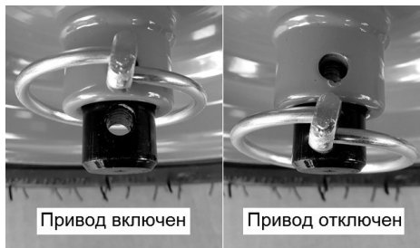
Рис. 36 Перестановка шплинта на левом колесе
